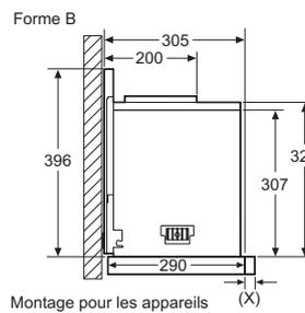
Montage pour les appareils avec cadre d'abaissement.
