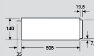
Il est possible d'installer des fours compacts d'une hauteur de 455 mm sur un tiroir chauffant. Aucun faux-plancher n'est nécessaire.
