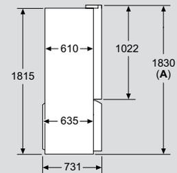
**A:** La façade est réglable de 1830–1847 mm, avec les pieds de nivellement avant à sortie totale
