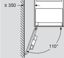
En cas d'utilisation du limiteur d'angle de 92°, la distance minimale par rapport au mur n'est que de 100 mm.
