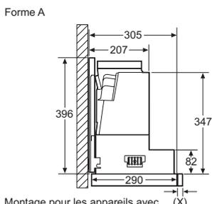
Montage pour les appareils avec cadre d'abaissement.
