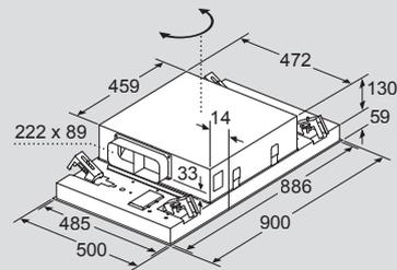
La sortie du ventilateur peut être orientée dans les quatre directions
