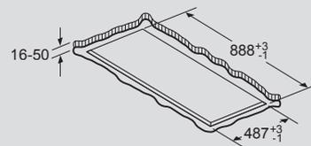
Ne pas monter directement dans la plaque de plâtre ou autres matériaux légers similaires du plafond suspendu. Une structure appropriée est nécessaire, solidement fixée dans le plafond en béton.
