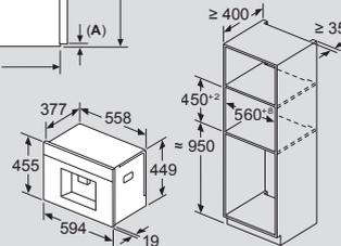
Les réservoirs de grains et d'eau peuvent être retirés par l'avant. Hauteur d'installation recommandée 950-1 450 mm
