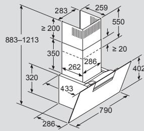
Appareil en mode circulation d'air sans conduit
