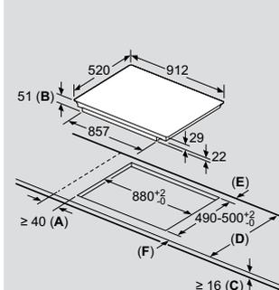
A: Distance minimum entre la découpe de la plaque de cuisson et le mur.
