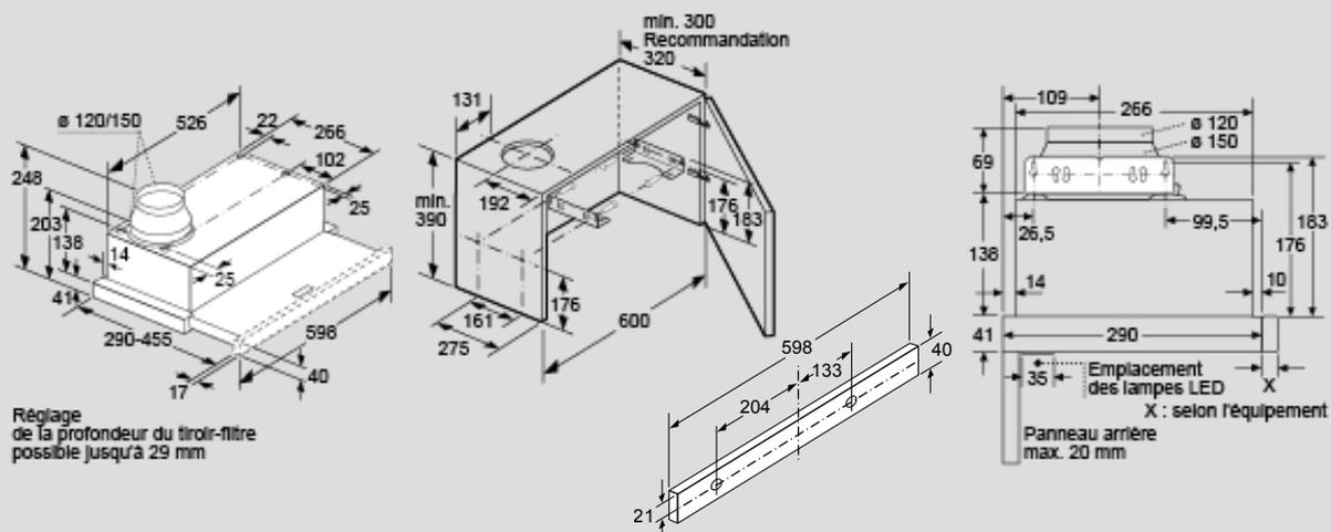
Réglage de la profondeur du tiroir-filtre possible jusqu'à 29 mm
