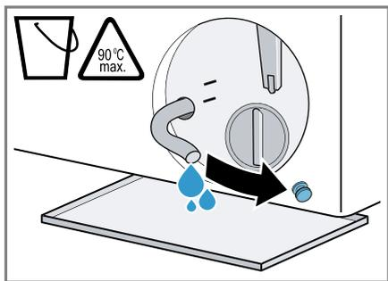
8. Appuyez sur le bouchon de fermeture.
