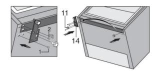
Fixez la charnière (14) sur le côté opposé à l'aide des vis. Les vis doivent être fixées dans l'ordre indiqué sur la figure ci-dessous. Tout d'abord, serrez la vis 1, puis les vis 2. Ensuite, vissez les pieds réglables (11).
