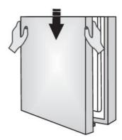
Placez la porte sur la charnière inférieure et utilisez les vis (2) pour fixer la charnière supérieure (3). Maintenez la porte en place tout en la positionnant.
