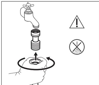
**Pour préserver la qualité de l'eau potable, un clapet antiretour fermé doit être installé entre le robinet d'eau et le tuyau d'arrivée d'eau.**
