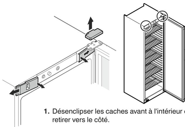
1. Déclipser les caches avant à l'intérieur et les retirer vers le côté.
