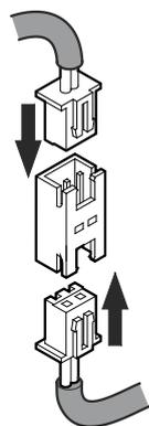
27. Enclipser l'ensemble de connecteurs sur le support.
