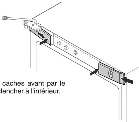
15. Accrocher les caches avant par le côté et les enclencher à l'intérieur.
