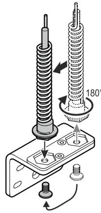
10. Dévisser le pivot, le tourner à 180° en le maintenant à l'horizontale et le revisser dans l'orifice gauche.
