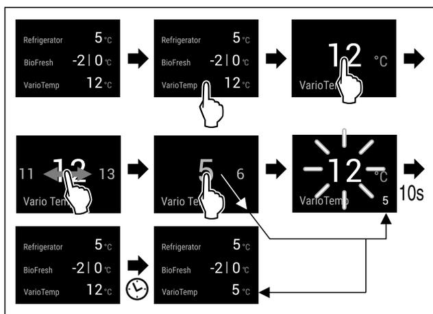
Fig. 37 Représentation à titre d'exemple : Modifier VarioTemp de 12 °C à 5 °C pour un réfrigérateur-congélateur combiné avec compartiment Fish & Seafood.\*
