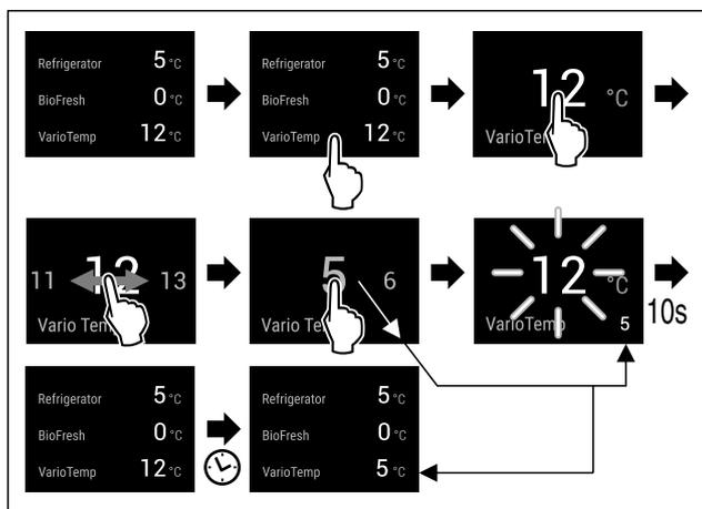
Fig. 36 Représentation à titre d'exemple : Modifier VarioTemp de 12 °C à 5 °C pour un réfrigérateur-congélateur combiné avec BioFresh.\*
