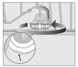
Remettez le bras de lavage central en place et tournez le raccord dans le sens inverse des aiguilles d'une montre jusqu'à ce qu'il s'enclenche. Veillez à ce que les encoches du verrou soient superposées.
