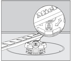
■ Tournez le raccord fileté dans le sens horaire jusqu'à ce que la pointe de la flèche dans la lucarne indique le symbole du verrou n.
