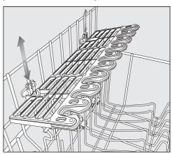
Déplacez le repose-verres à la hauteur voulue, vers le haut ou vers le bas jusqu'à ce que les fixations s'encliquettent.
