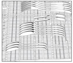
Lorsque les cuillères ne peuvent pas être insérées entre les supports, placez-les de sorte que les poignées reposent sur les supports dentelés.
