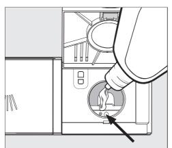
■ Remplissez le réservoir de produit de rinçage jusqu'à ce l'indicateur de niveau (la flèche) devienne foncé avec la porte ouverte à l'horizontale.
